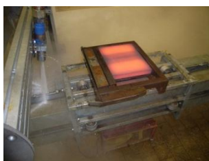
Obr. 3 Experimentální zařízení pro měření HTC v Laboratoři přenosu tepla a proudění
