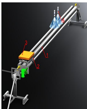
Obr. 3 Experimentální zařízení pro měření HTC v Laboratoři přenosu tepla a proudění
