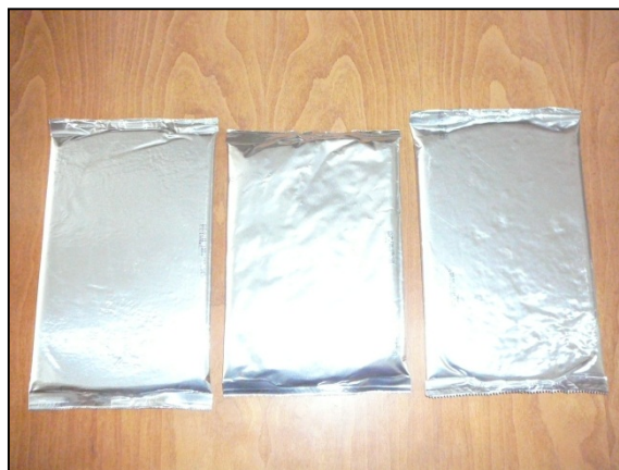
Obr.2.10 Hliníkové polštářky s PCMs (autor)
