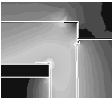
Obr. 5.7 Řez modelem virkatoru – vyhodnocení modulu intenzity elektrického pole E
