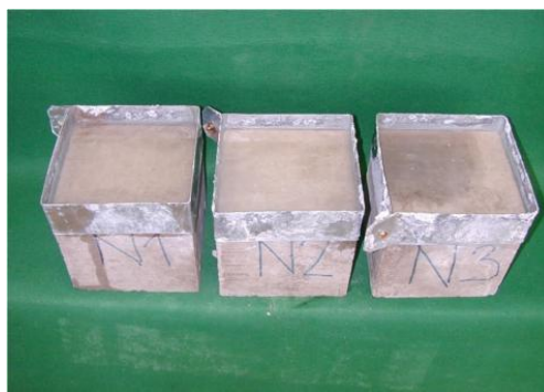
Obr. 2.5 Změna vzhledu filmu nové disperze operace 1/2010 po 60 cyklech
