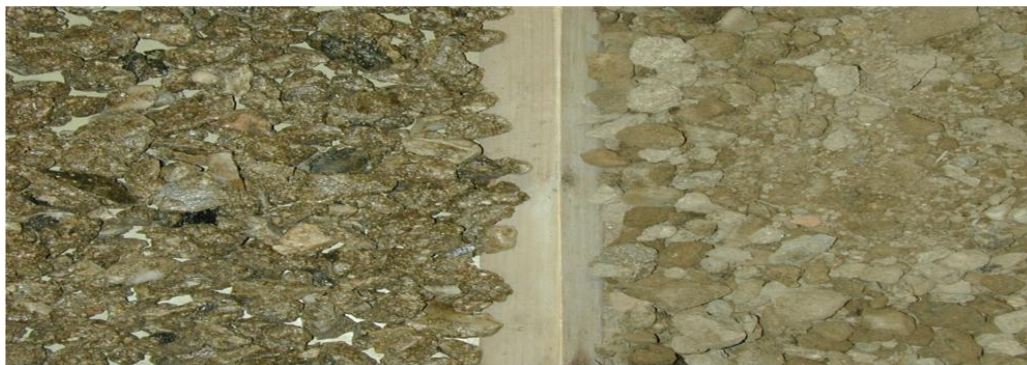
Obr. 3.5 Disperzí penetrovaný a sou asn aglomerovaný recyklát fy. Dufonev, frakce 4-31,5 mm (vlevo); neupravený surový recyklát fy. Dufonev, frakce 0-16 mm (vpravo)
