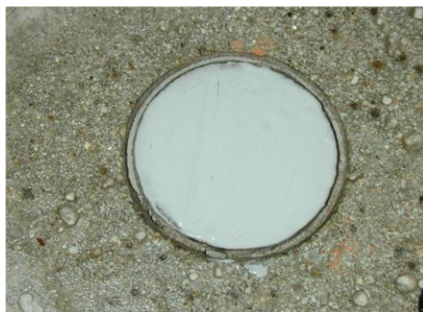
Obr. 5.2 tenká vrstva nanesená na povrch testovaného adheziva typu I. – broušený a penetrovaný betonový adherend
