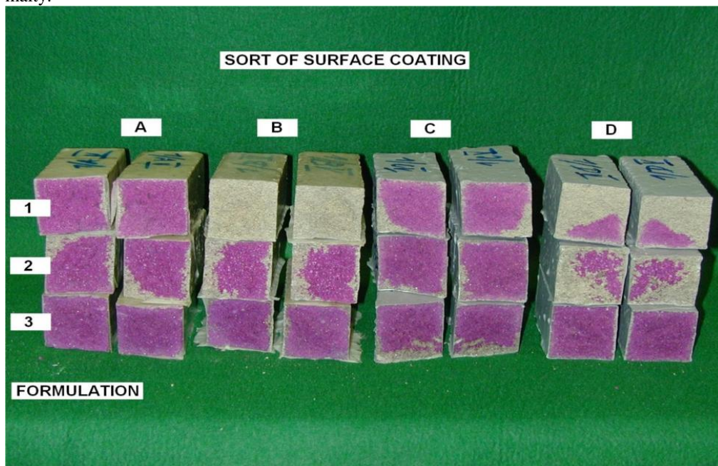
Obr. 4.1 12. m síc uložení v 98% CO 2 , nát r A, B, C a D na rec. 1, 2 a 3, pr m rné hloubky karbonatace pod nát rem A: 1, 3, 0 mm, B: 20, 5, 1 mm, C: 2, 1, 2 mm a D: 15, 15, 0 mm
