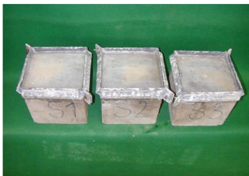
Obr. 2.4 Změna vzhledu filmu staré disperze operace 5/2008 po 60 cyklech
