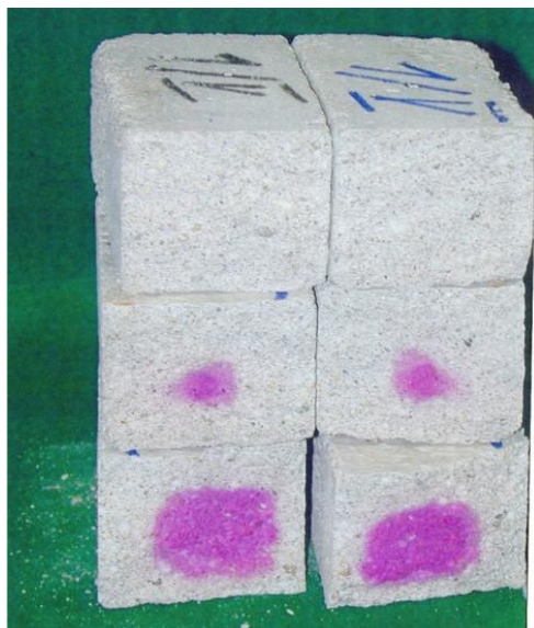
Obr. 4.2 12. m síc uložení v 98% CO 2 , bez nát ru, rec. 1, 2 a 3, pr m rná hloubka karbonatace: 20, 15 a 10 mm
