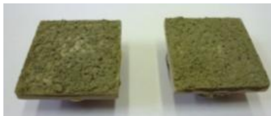
Obr. 10 Porušení soudržnosti hmoty při odtrhu lepidla A/6+FA50.
