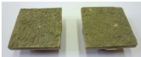
Obr. 9 Porušení soudržnosti hmoty při odtrhu referenčního lepidla.
