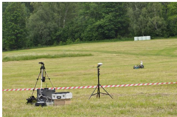
Obrázek 27: Robot Orpheus-X3 upravený pro měření gama záření (vlevo), průběh experimentu včetně referenční stanice GNSS a vymezení nebezpečné zóny (vpravo).
