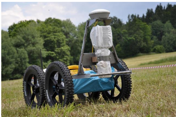
Obrázek 27: Robot Orpheus-X3 upravený pro měření gama záření (vlevo), průběh experimentu včetně referenční stanice GNSS a vymezení nebezpečné zóny (vpravo).
