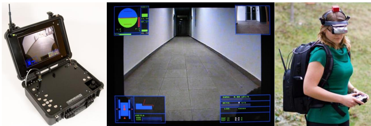
Obrázek 5: Zodolněná operátorská stanice (vlevo), snímek uživatelského rozhraní této stanice (vprostřed), nositelná operátorská stanice včetně teleprezenčního modulu (vpravo).
