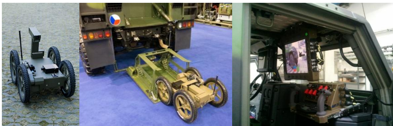
Obrázek 8: Orpheus-AC2 - robot (vlevo), zadní část CBRN vozidla se záchytným systémem (vprostřed), kokpit vozidla s displejem operátorské stanice (vpravo).
