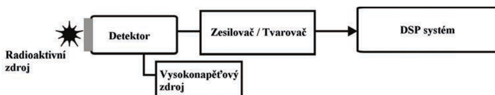
Obrázek 3 | Blokový diagram standardního DSP spektroskopického systému.
