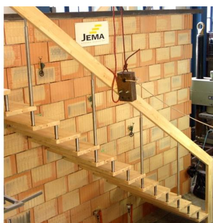
Obr. 39: Dynamická rázová zkouška madla A.
