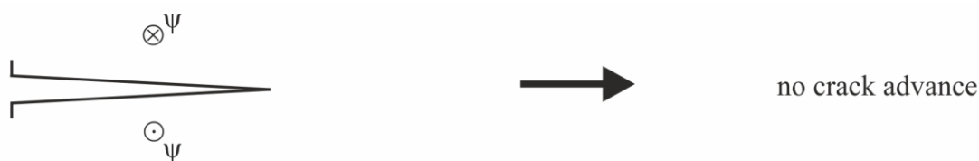
Obrázek 6: Ideální model nešíření trhliny v módu III dekohezí [16]
