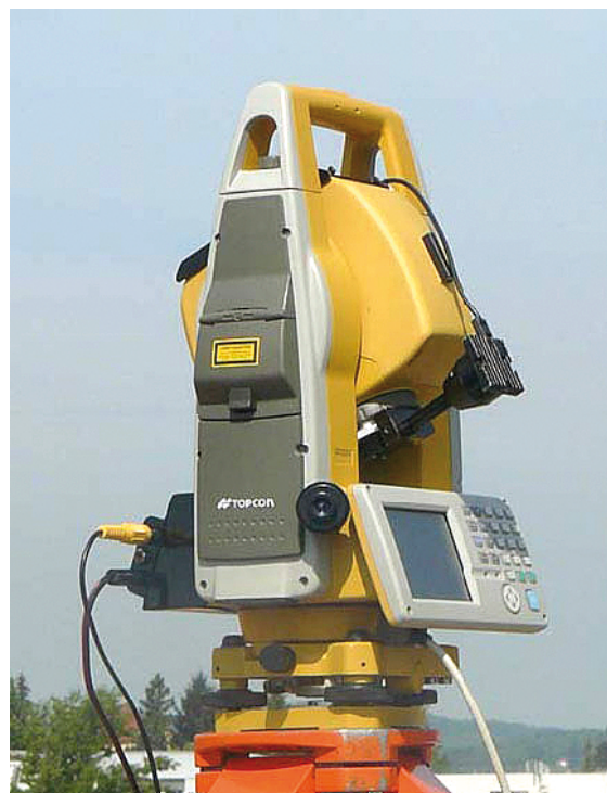
Obr. 4.4 Upevnění kamery na MAAS-1
