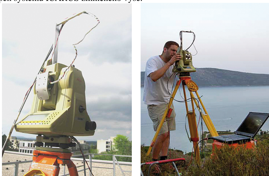
Obr. 3.1 Totální stanice Leica TCA 1800 se systém DAEDALUS ( Bürki a Guillaume 2011 )
