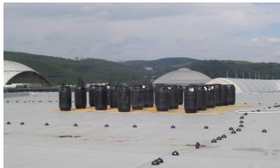
Obr. 27 Rozmístění sudů ve II. fázi zatěžovací zkoušky.
