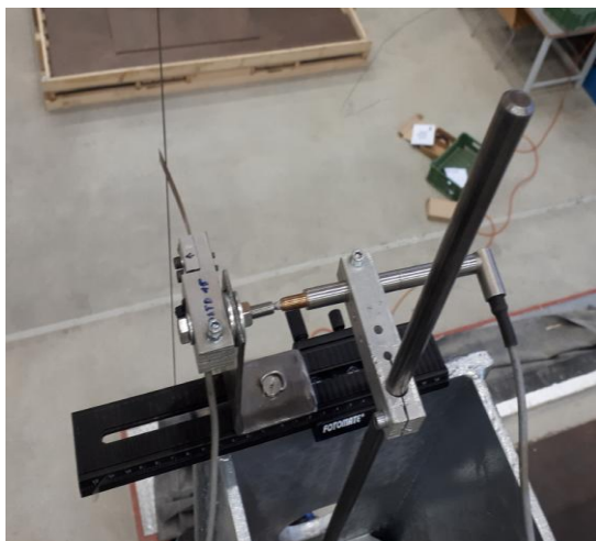
Obr. 38 Experimentální stanovení koeficientu tuhosti svislého lanka.
