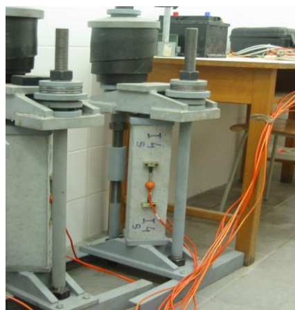
Obr. 4 Dotvarovací lisy s osazenými hranoly.
