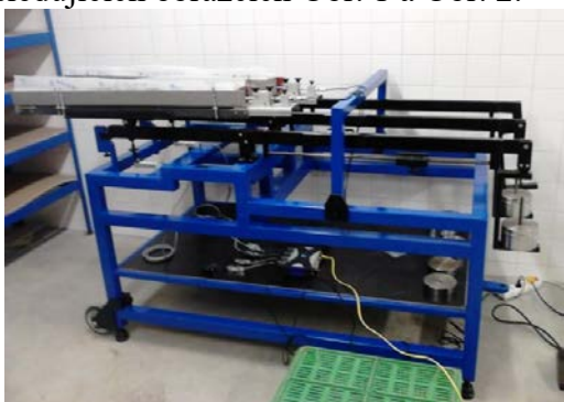
Obr. 1 Finální provedení váhového stolu.
