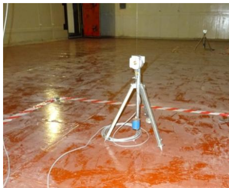
Obr. 43 Potenciometrický snímač MS04 instalovaný v plynojemu P1.
