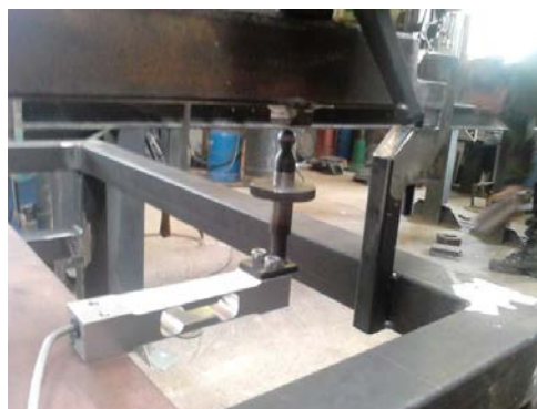
Obr. 2 Detail váhového členu s rektifikačním šroubem.
