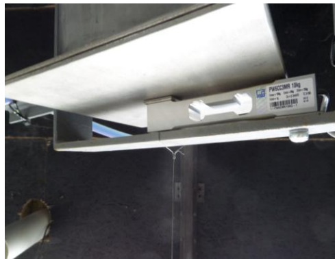
Obr. 23 Detail váhového členu umístěného na závěsu s osazenou patní deskou pro nádobu.
