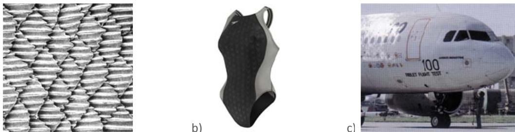
Obr. 2 a) topografie povrchu kůže žraloka [5], b) plavky imitující kůži žraloka [speedo.com], c) povrch letadla Cathy Pacific Airbus 340 je pokryt transparentním plastickým filmem imitující kůži žraloka [5]
