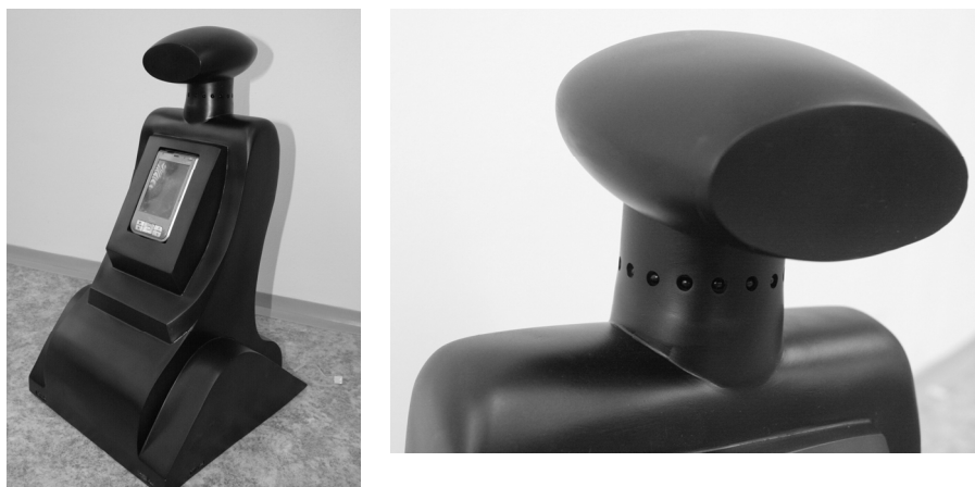
Obr. 6.3 Testovací robot Leela a detail umístění scanneru majáků.
