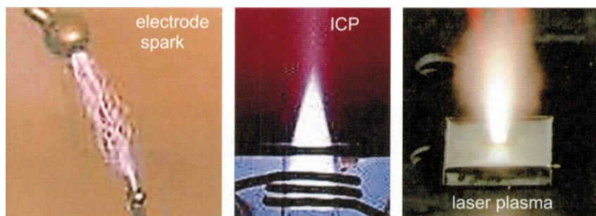
Obr. 1 Fotografie konvenčního jiskrového výboje ( electrode spark ), indukčně vázaného plazmatu (ICP) a laserem buzeného plazmatu ( laser plasma ). Měřítka jednotlivých fotografií jsou různá. Převzato z [2].
