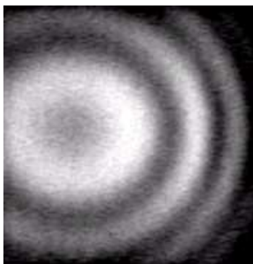
Obr. 7 Obraz vzorku tenké vrstvy pro vlnovou délku \lambda = 600 nm světla na výstupu monochromátoru. Vrstva byla připravena metodou PECVD na monokrystalu Si v plazmochemickém reaktoru II. Materiál vrstvy byl tvořen směsí CN x a SiO y .
