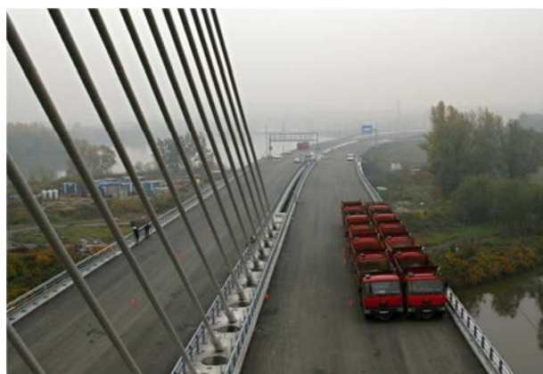
Obr. 6.5 Nesymetrické zatížení levého mostu – zavěšená část
