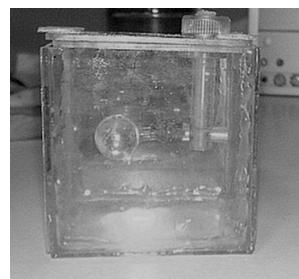
Obr. 20 Měřený přípravek s nehomogenitou
