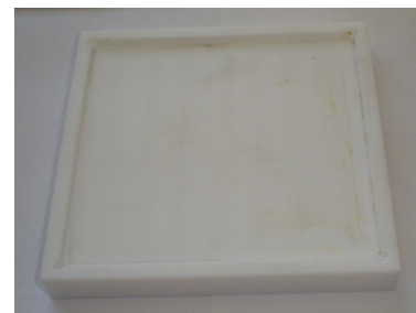
Obr.6.1. Plastový přípravek pro eloxování
