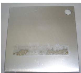
Obr.6.4. Naeloxovaný hliníkový plech s místem, kde byla přitlačena svorka
