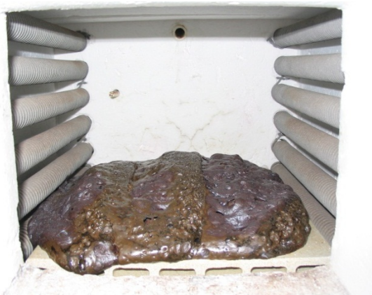
Obr. 13 Roztavení AAP materiálu během výpalu na teplotu 1200 °C.
