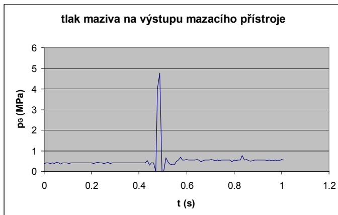
Obr. 11 Grafické výsledky měření tlaku maziva p_1 za mazacím přístrojem při zátěži m = 4,4\text{kg} na měřicím válci
