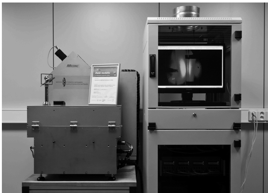
Obr. 19. Automatický systém pro bezkontaktní kalibraci koncových měrek.
