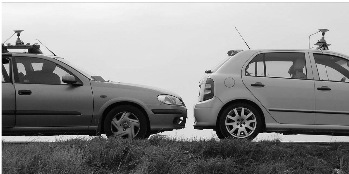
Obr. 5.1 Antény GPS jsou umístěny na nosičích na střeše vozidel. Vlastní přístroje jsou umístěny ve vozidle. Vozidla jsou na fotografii zachycena při klidovém měření minimální vzdálenosti mezi vozidly (kalibraci). Pro měření se používala až tři vozidla a čtyři aparatury GPS – jedna jako referenční v blízkosti silnice.
