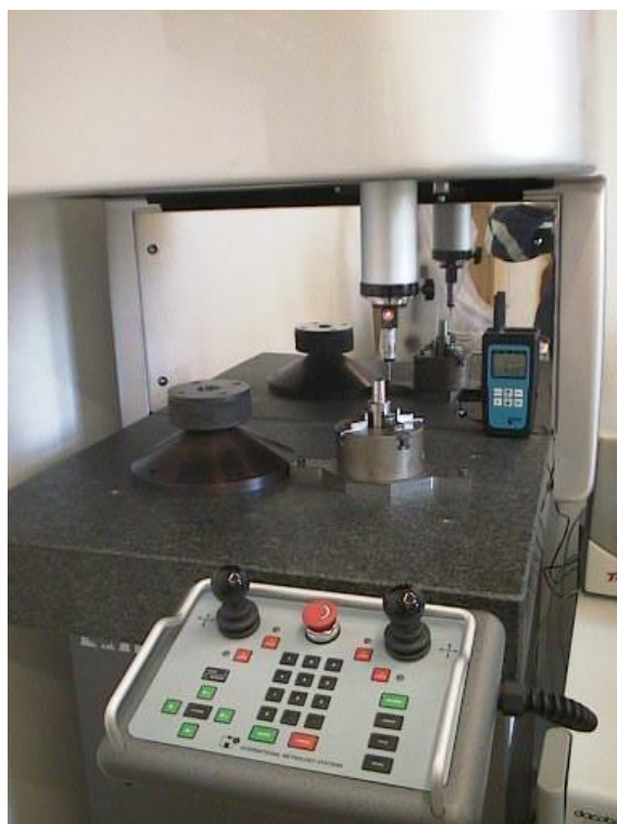
Obr. 2: Model analyzované soustavy, zatížené dle ISO 7206-5 a měřicí zařízení IMS UMPIRE.
