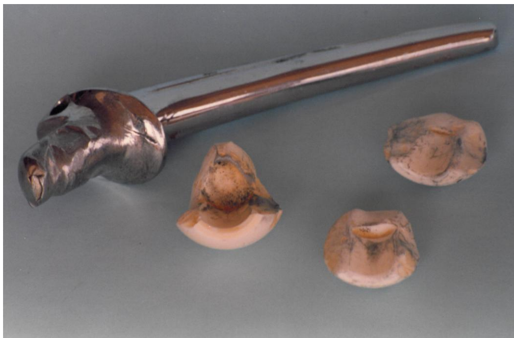
Obr. 1: In vivo destruovaná hlavice a dřík se zplastizovaným kuželem.
