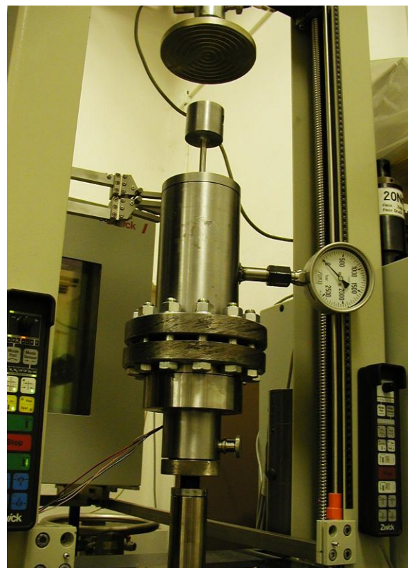
Obr. 18: Schéma zatížení hlavice a destrukční zařízení.
