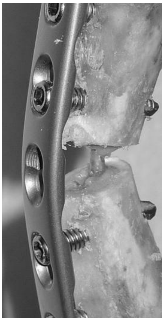
Obr. 2.6.3 Deformace soustavy femuru mini prasátka s dlahou a hřebem.
