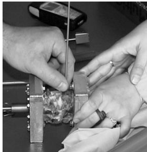
Obr. 2.2.1.5 Aplikace fixátoru Cervi Lok do vzorku
