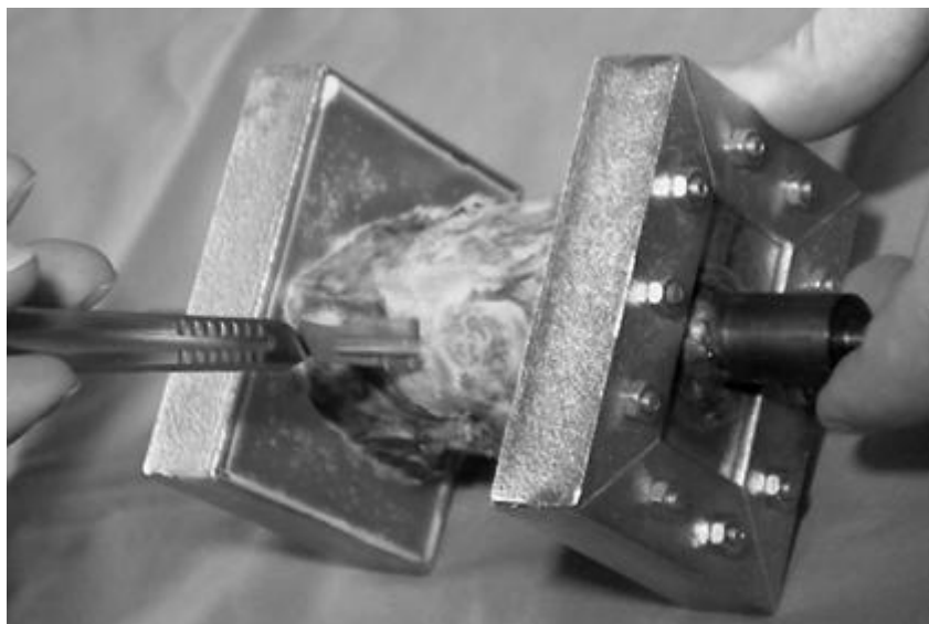
Obr. 2.2.3.1 Porušení páteřního segmentu – porušení páteřní destičky
