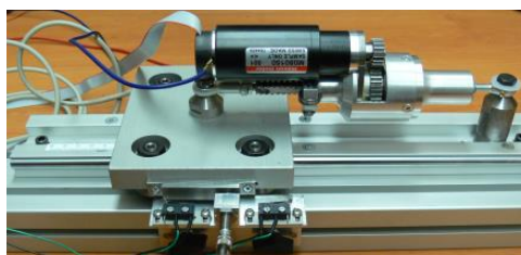
Obr. 9 Testování lineárního akčního členu
