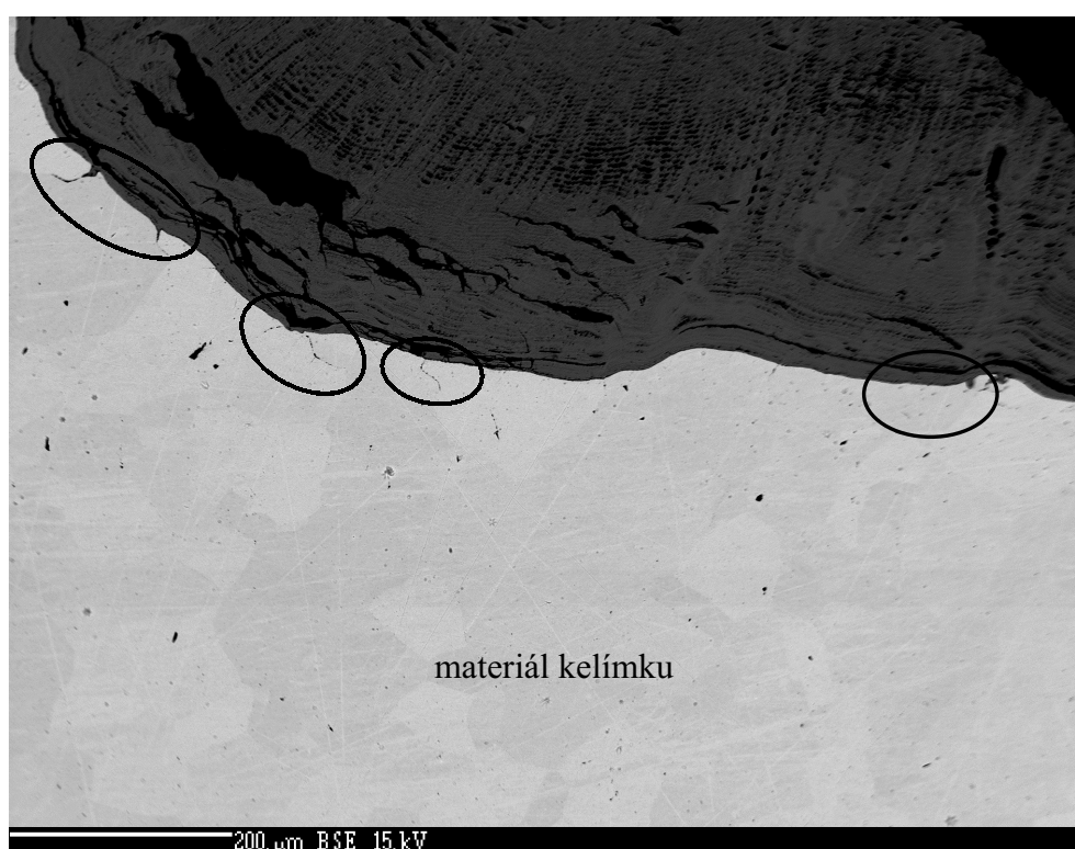
Obr. 6.4. Dno kelímku po korozním experimentu (zvětšeno)
