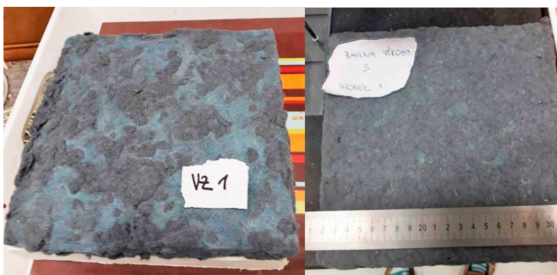
Obr. 18: Izolant na bázi bavlny před optimalizací výrobního procesu (vlevo) a po optimalizaci (vpravo)
