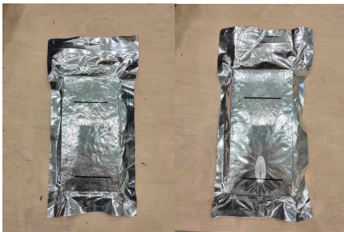
Obr. 20: Fotografie vzorku VIP (bariérové fólie) před, a po zkoušce malým zdrojem plamene [28]
