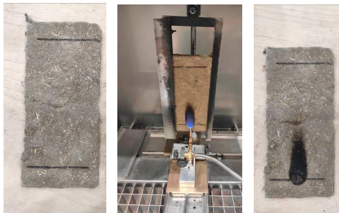
Obr. 19: Fotografie vzorku lnu před, během a po zkoušce malým zdrojem plamene [28]
