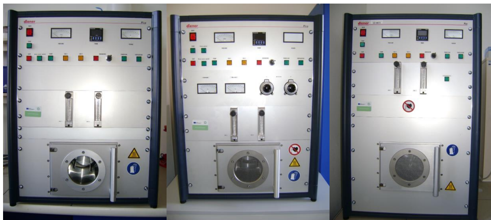
Obr. 20. Reaktor vysokofrekvenční (40 kHz), radiofrekvenční (13,56 MHz) a mikrovlnný (2,45 GHz)
