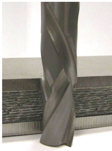
Obr. 2 Frézování kompozitu speciální válcovou frézou [16].
