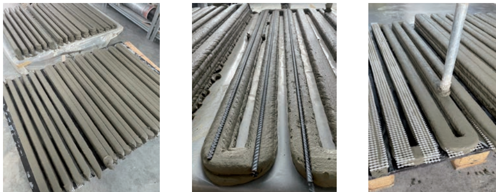
Obr. 36: Zkušební vzorky pro stanovení materiálových vlastností pytlované prefabrikované směsi 3DCP MASTERFLOW 3D 100 používané pro 3DCP.
