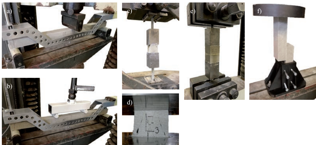
Obr. 27: Stanovení modulu pružnosti MOE a pevnosti v tahu za ohybu MOR pro 3BO (a), 4BO (b), pevnosti v prostém tahu f_i (c), pevnosti v prostém tlaku f_c (d), pevnosti lepeného spoje dvou CFB v tahu f_{g,t} (e) a ve smyku f_{g,s} (f).
