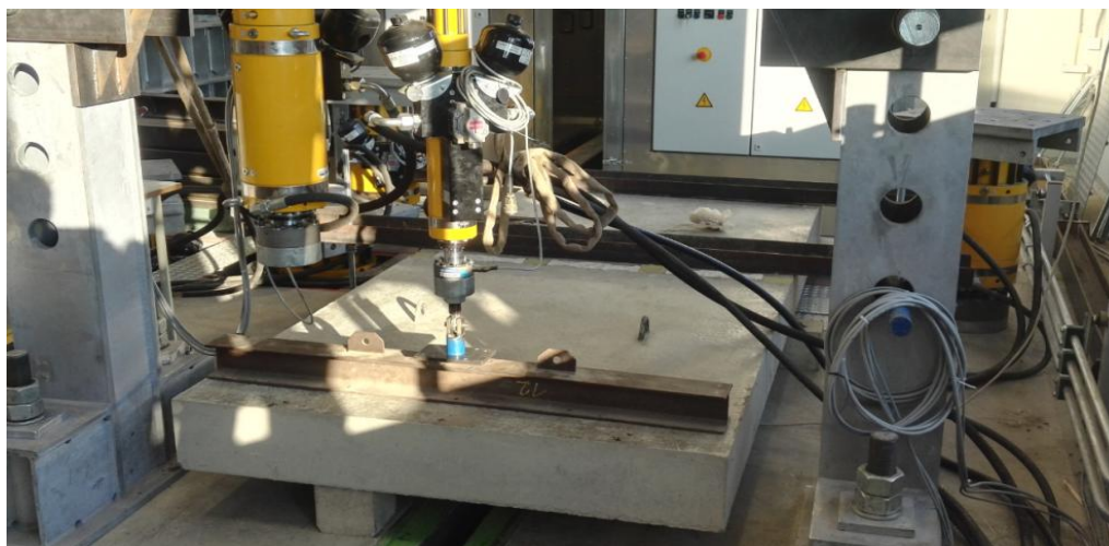
Obr. 34 Vzorek č. 14: i-KORB_330/T410/S206/C230-h200-P30-I.S3-S před zahájením zkoušky
