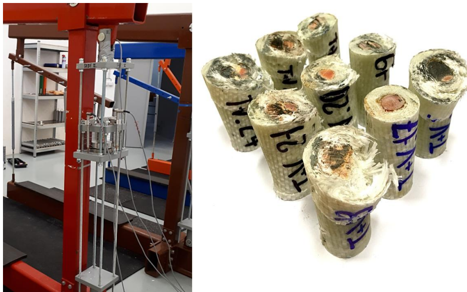
Obr. 28 Zkouška tlakového elementu; vlevo: zkušební zařízení; vpravo: porušení vzorků
