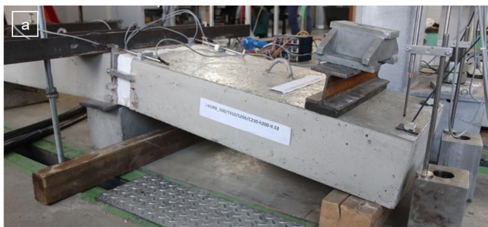
Obr. 30 Uspořádání statické zatěžovací zkoušky, způsob ukotvení vzorku
