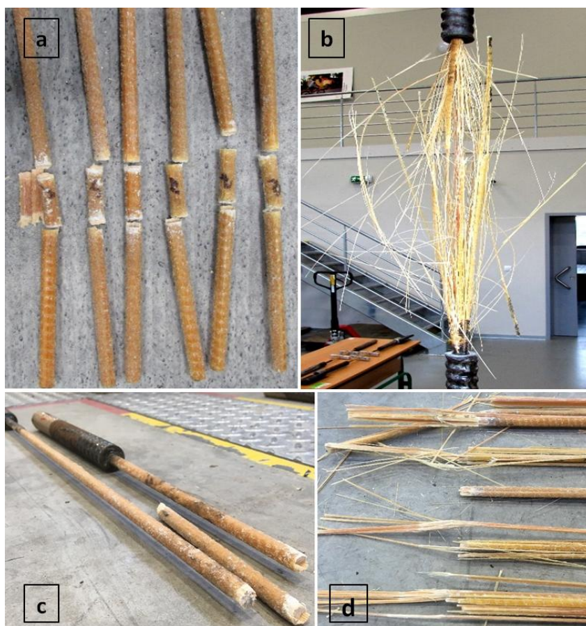
Obr. 22 Porušení vzorků GFRP výztuže PREFA ReBAR : a) namáhání čistým smykem; b) čistý tah; c) namáhání N+V- nízká hladina tahové síly; d) namáhání N+V- vyšší hladina tahové síly
