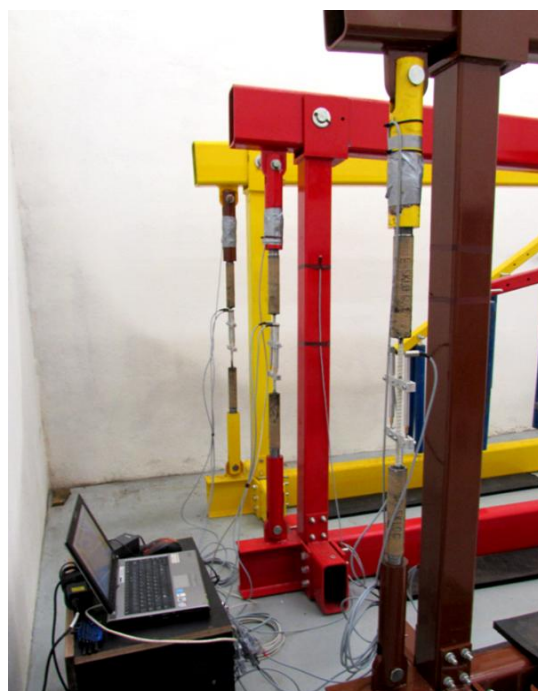
Obř. 3 Schéma a reálné provedení zkušebního zařízení pro dlouhodobé tahové zkoušky
