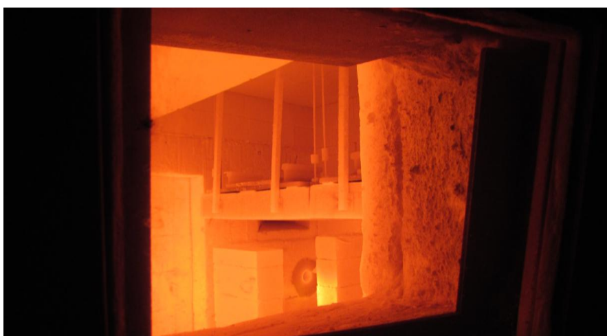
Obr. 36 Vzorky v peci v průběhu požární zkoušky
