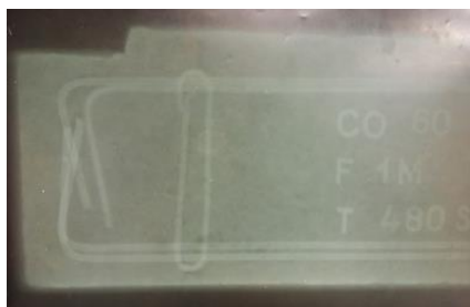
Obr. 2 Radiogramy téhož prvku (železobetonový prefabrikát tloušťky 70 mm vyztužený pruty výztuže Roxor 8 mm), vpravo gamagram, vlevo rentgenogram, je dobře patrná výrazně vyšší jakost rentgenogramu.
