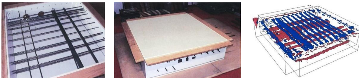
Obr. 13 Testování možnosti georadaru Hilti PS1000 X-scan na fyzikálním modelu: vlevo model před naplněním pískem, uprostřed připravený pro měření a vlevo jeden z 3D výstupů testovacího měření.
