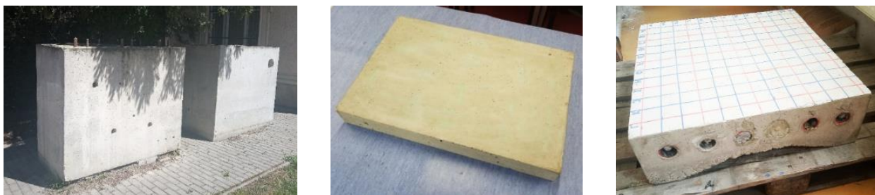
Obr. 14 Různá podoba stabilních modelů, vlevo osmitunové masivní bloky obsahující měkkou i předpínací výztuž i nehomogenity v betonu, uprostřed jednoduché desky simulující spodní částí průvlaku v konkrétním železobetonovém monolitickém skeletu, vlevo model spodní části jedné z variant předpjatého nosníku KA-73.
