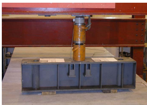
Obr. 6.5 Roznos bodového zatížení do příčného směru
