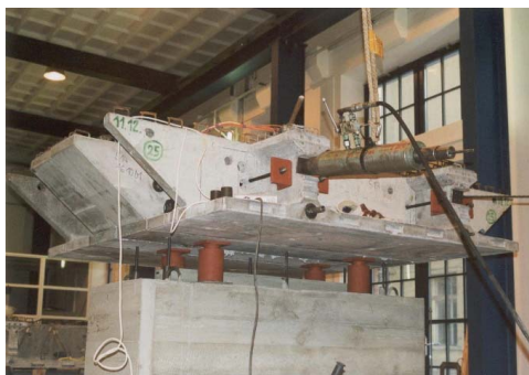
Obr. 7.11 Letmá montáž segmentů
