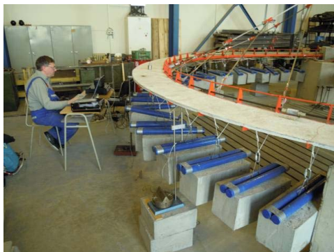
Obr. 9.1 Měřicí ústředna, induktivní snímač polohy (průhybů)
