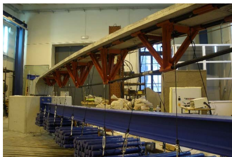
Obr. 2.3 Testování navržené konstrukce na fyzikálním modelu
