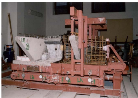
Obr. 7.10 Kontaktní výroba prefabrikovaných segmentů
