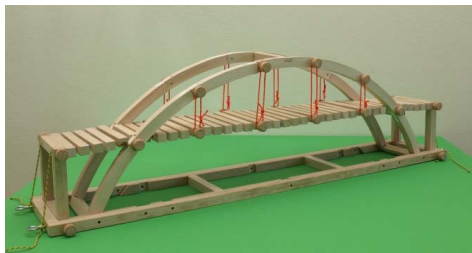
Obr. 10.3 Oblouková mostní konstrukce
