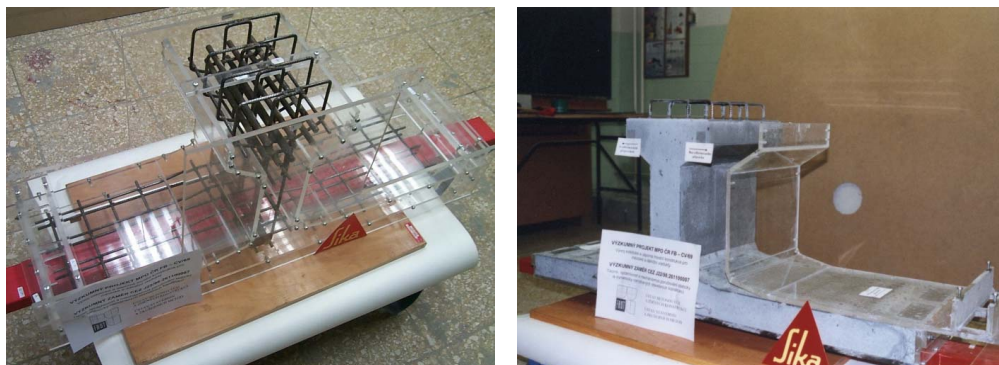
Obr. 5.1 Zkušební betonáž, ověření betonové směsi
