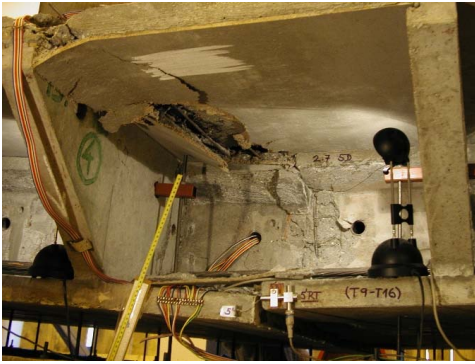
Obr. 7.16 Porušení konstrukce modelu v kritickém řezu
