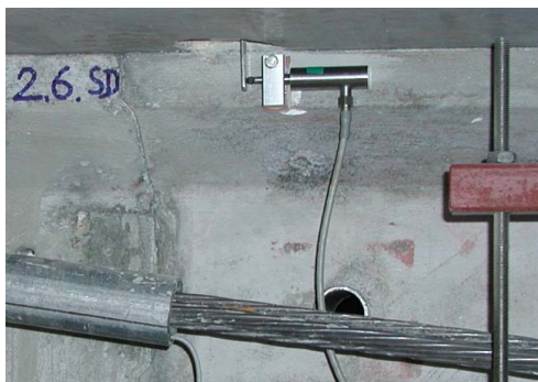
Obr. 6.2 ME snímač na vnějším kabelu a měření posunu spřažené desky
