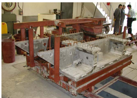
Obr. 7.10 Kontaktní výroba prefabrikovaných segmentů
