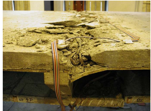
Obr. 7.16 Porušení konstrukce modelu v kritickém řezu
