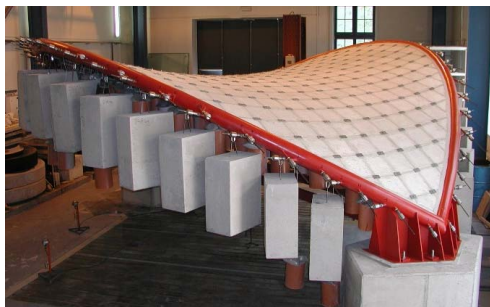
Obr. 7.22 Model střešní konstrukce
