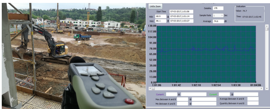
Obrázek 4 Záběry z reálného měření hluku z výstavby hlukoměrem, staveniště výstavby bytových domů se souběžně zapojenými mechanismy s ukázkou stažení dat v Peak Tech 8005 [©kantova.r@fce.vutbr.cz]
