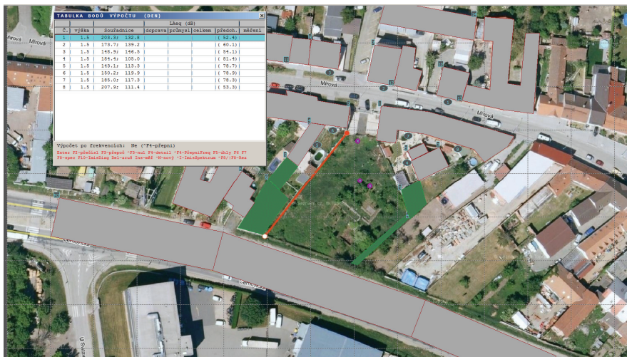
Obrázek 15 SM model v prostředí HLUK plus, screenshot, akusticky významné stavební stroje jako zdroje hluku a označená místa měření pro řešení území zadávané do modelu s generovanou tabulkou hodnot [©kantova.r@fce.vutbr.cz]
