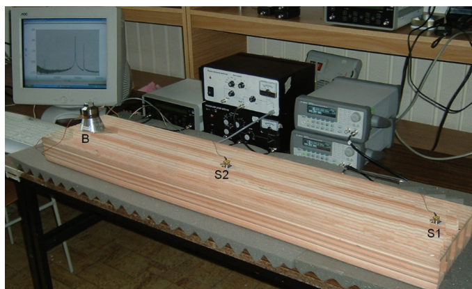
Obr. 15 Ukázka stropní desky s vyznačenou polohou budiče B a pozicemi snímače (S1, S2) při aplikaci metody s jedním budícím signálem
