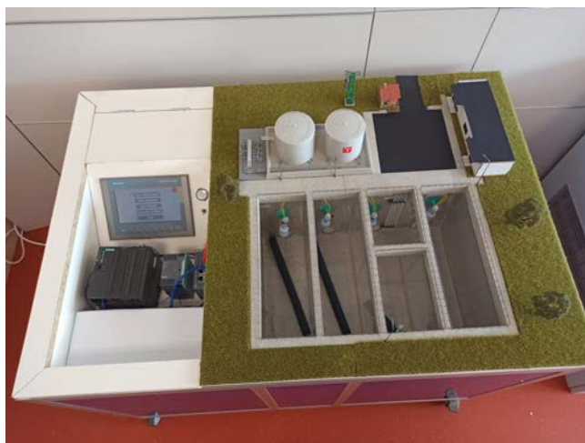
Obr. 3.5: Fotodokumentace experimentálního pracoviště (ČOV).
