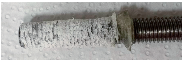
Obr. 3-11 Vzorek receptury 531-AN2609 po zkoušce po 72 hodinách v 5 °C
