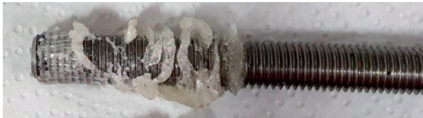
Obr. 3-10 Vzorek lepidla receptury 531-AN2609 po zkoušce po 15 hodinách v 5 °C
