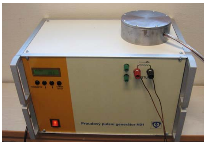
Obr. 6.1 První verze generátoru s připojenou aplikační cívkou v ocelovém stínění
