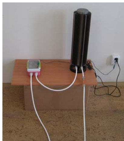
Obr. 5.4 Uspořádání soustavy vodního vyrovnávání teploty vzorků při experimentech
