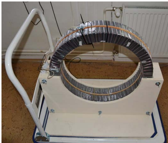
Obr. 5.1 Realizovaná soustava dvou 600 mm toroidů
