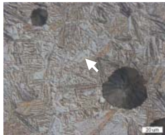
Obr. 14 : Mikrostruktura ADI H380 b ( \tau_t = 60 min.): bainitický ferit, stabilizovaný austenit (viz .šipka)
