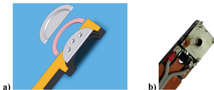
Obr. 6.2: Akustický senzor: a) model; b) realizovaný prototyp
