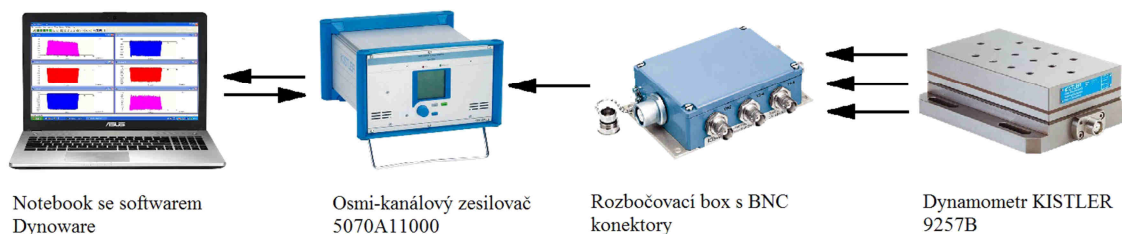
Obr. 9 Schéma měřicí aparatury Kistler.
