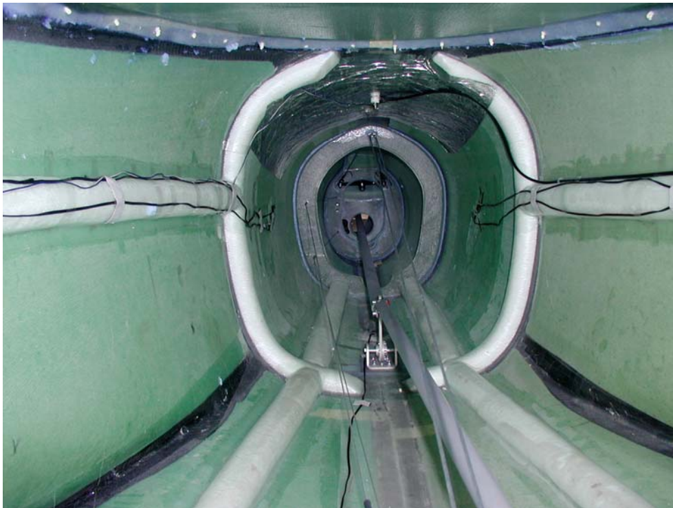
Obr. 10: Trup letounu TL – 2000 Sting s nalepenými tenzometry
