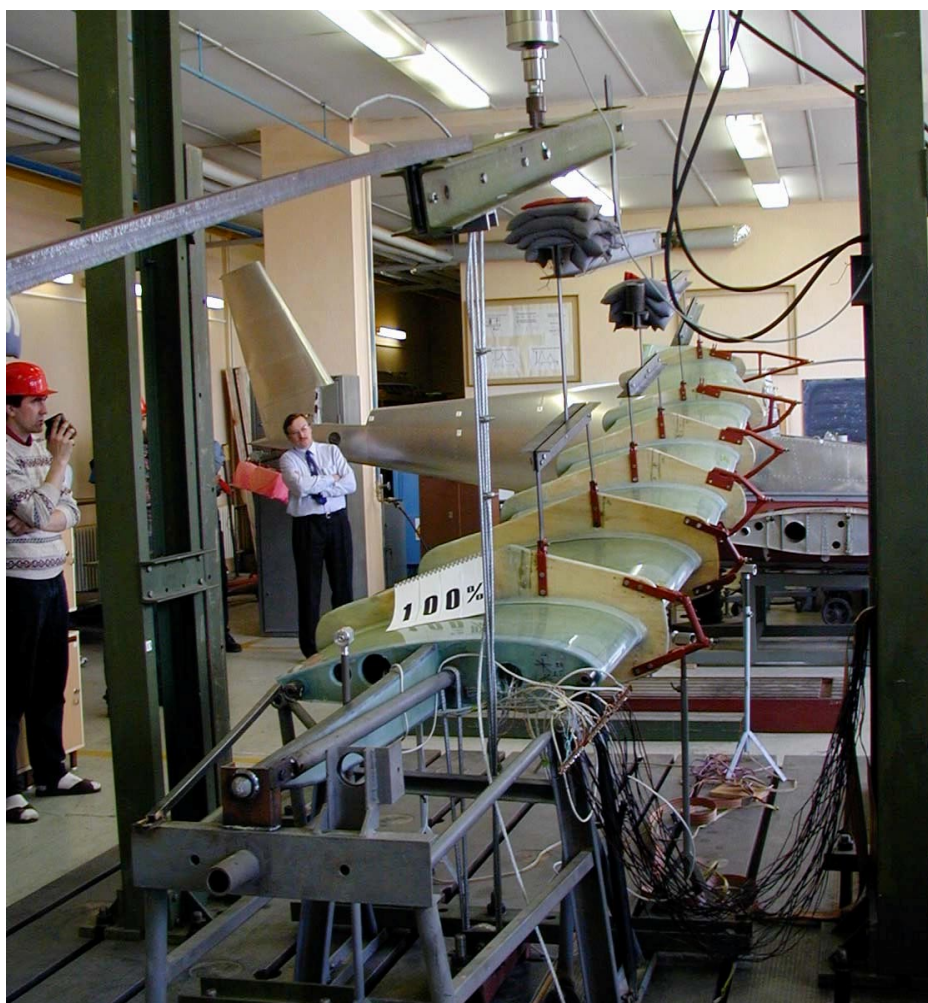
Obr. 6: Zkouška křídla – případ 1, 100 % početního zatížení
