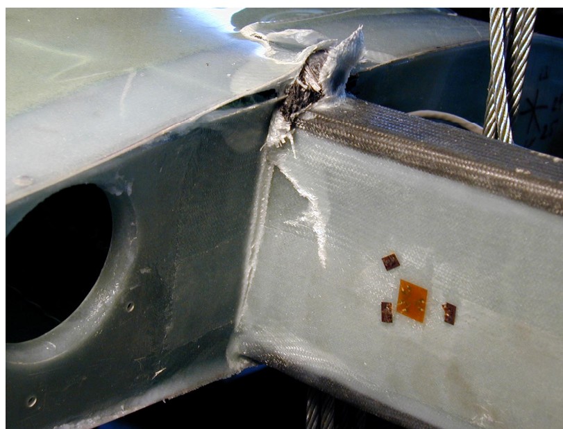
Obr. 7: Zkouška křídla – porucha
