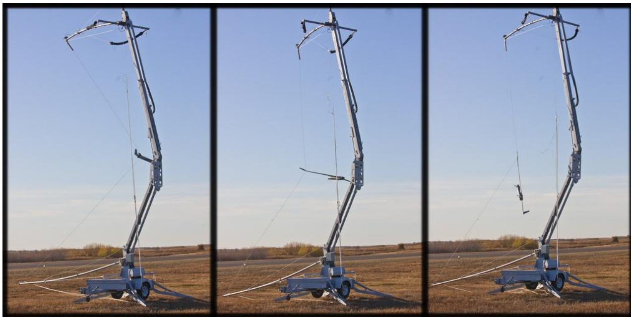
Obrázek 2: Zachycení UAV pomocí záchytného lana, převzato z: http://scerakorphotography.blogspot.cz/2011/12/scaneagle-uav-capture.html
