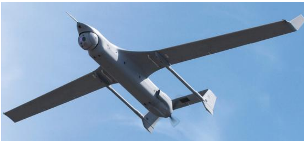
Obrázek 4: Dvoutrupé UAV bez podvozku, Insitu Integrator, převzato z: http://defense-update.com/newscast/0810/insitu_stuas_02082010.html
