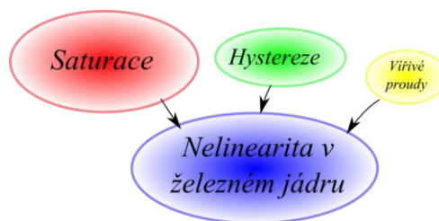
Obr. 2.4 Převážné vlivy na nelinearitu v železném jádru
