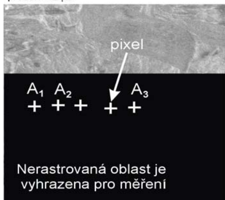
Obr. 2.2 Postup snímání časové závislosti signálu z obrazového bodu a kriteria pro výběr naměřených křivek S(t) .
