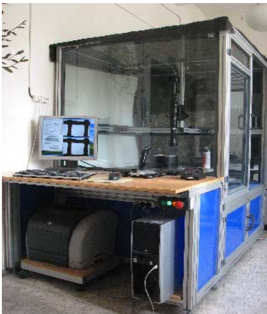
Obr. 6.1 Tester2D – akreditovaný měřicí systém pro testování průmyslových sít
