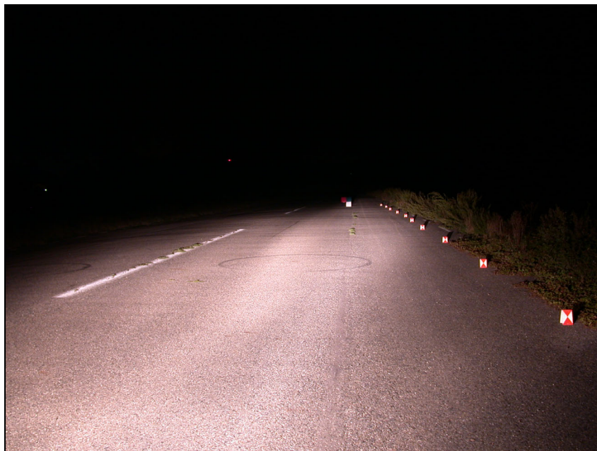
Snímek 4.1 Obrazová scéna řidiče při jízdě v noci a zapnutých potkávacích světlometech, vzdálenost terče 50 m
