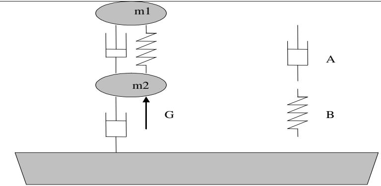
Obr. 1.1: Schéma pantografu (A-tlumič, B-pružina).
