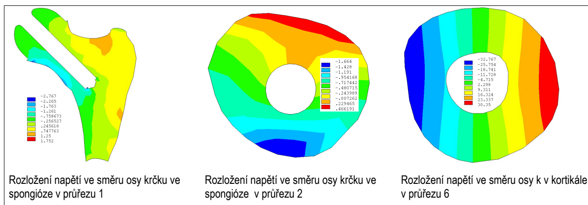
obr. 6.24 Varianta V4, fixace kostním cementem, chování kontaktu BONDED
